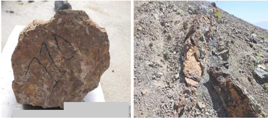
شکل ۳. الف: موجودیت زون های آلتريشنی کاربناتی به رنگ سرخ قهوه ای نما. ب: نمونه دستی از حجر کاربناتی منطقه مورد مطالعه.
